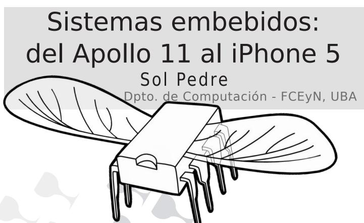
Un sistema embebido es un sistema diseñado para cumplir una o pocas funciones dedicadas y que está embebido como parte de algún dispositivo de hardware completo. Hoy en dia el 99% de los procesadores van a parar a estos sistemas: son el cerebro de casi todos los dispositivos electrónicos, desde juguetes hasta el control de plantas nucleares.
