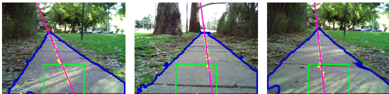
Figura: Detección de fronteras geométricas mediante la segmentación basada en contexto. Imágenes capturadas con el robot Exabot yendo del Pabellón 1 al Pabellón 2.
